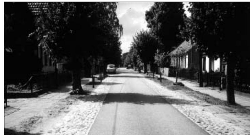
**Abb. 8** Gelungene Materialkombination in der Ortsdurchfahrt Himmelpfort (Uckermark): Schmale fahrradtaugliche Asphaltspur mit Randstreifen aus Feldsteinpflaster
