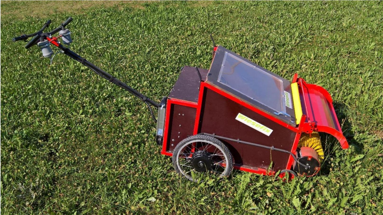
„Wiesefix“, Bürstenerntemaschine, Foto: LPV Unterallgäu
