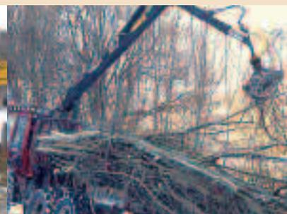
kann nahezu das ganze Astmaterial mit verwertet werden das sonst nicht als Brennholz geeignet wäre. Häcksler gibt es in unterschiedlichen Variationen, es können, je nach Gerät, Stämme bis zu 65–80 cm Durchmesser gehäckselt werden. Häcksler werden immer größer und leistungsstärker, ein damit verbundener Nachteil: dadurch auch immer teurer. Mittlerweile entstehen so Maschinenstunden von ca. 150 Euro.
