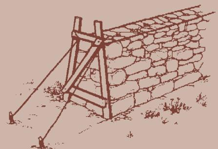
Die letzte Steinschicht wird sorgfältig auf dem Niveau der Richtschnüre ausgeebnet. Erst dann werden die Decksteine gesetzt.
