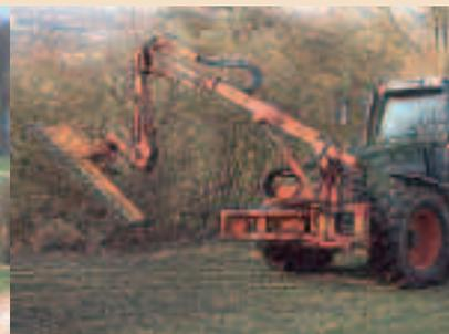
*Naarva-Grip Schnittkopf – ein Fäll- und Entnahmegreifer, der auch in der Heckenpflege gutes leistet*
