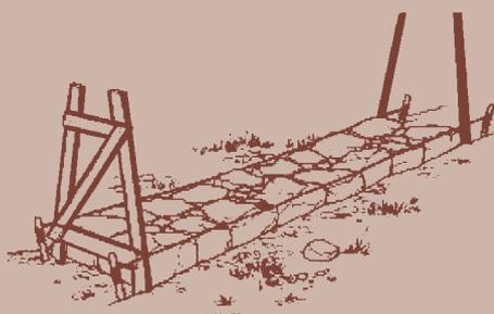
Das Fundament ist fertig. Alle Hohlräume zwischen den Fundamentsteinen wurden mit Schotter ausgefüllt.
