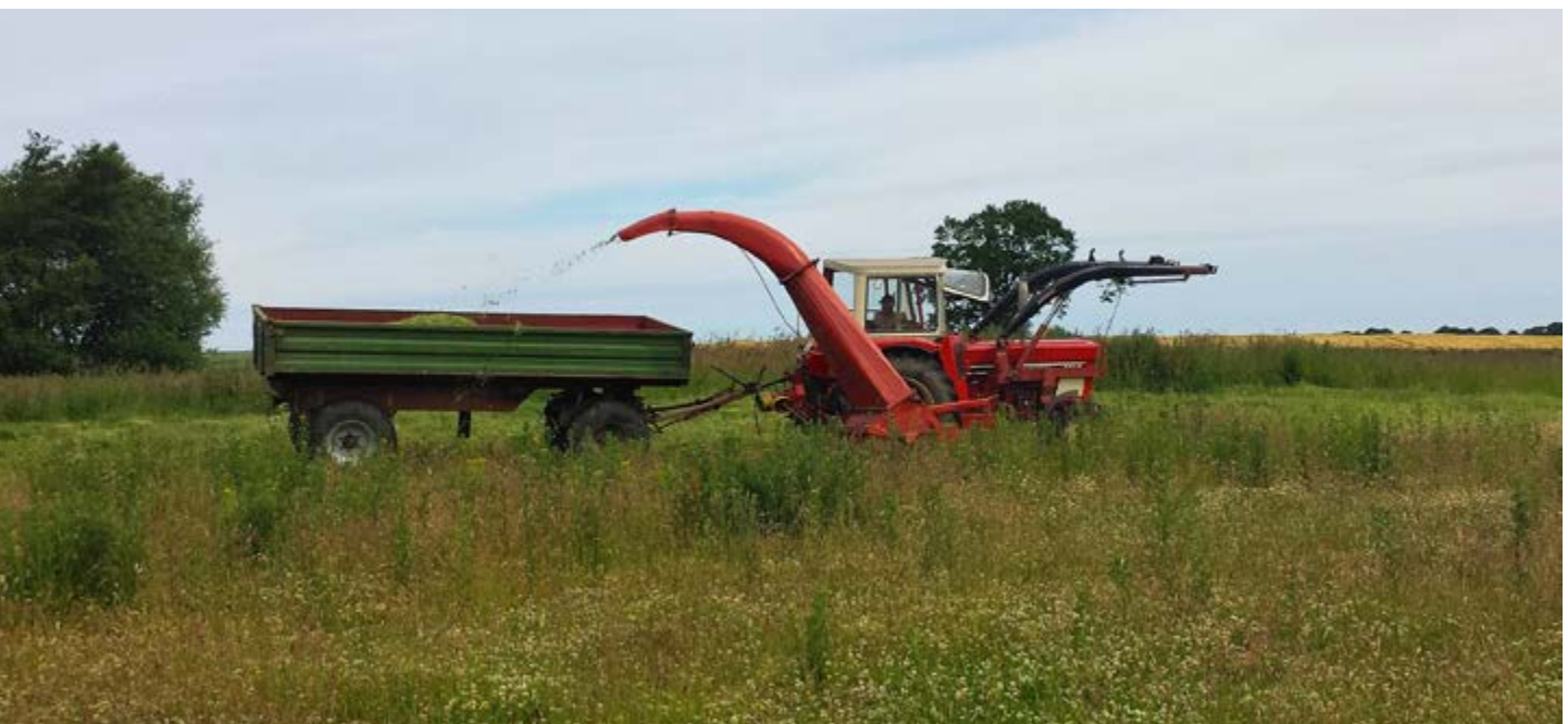
Mulchmäh einer Naturschutzfläche mit einem „Exakthäcksler“ nach der „Imkervariante“, 26. Juni 2015.
