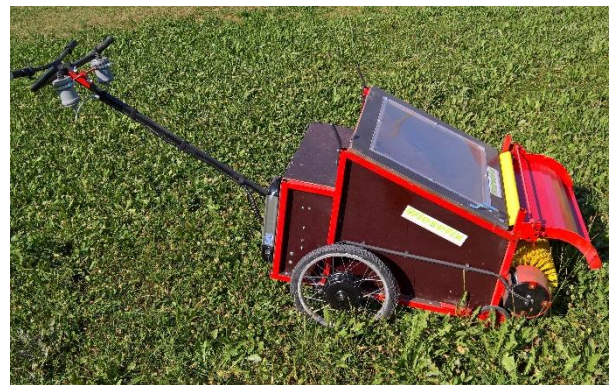
Der Wiesefix, speziell zur Samenernte auf artenreichem Grünland entwickelt. Foto: LPV Unterallgäu e.V.
