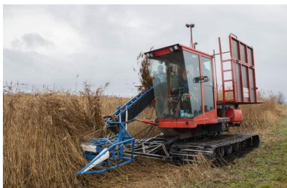
Mit angepasster Technik ist eine Mahd von Schilf, Rohrkolben oder Seggen auch auf nassen Flächen und gleichzeitig bodenschonend möglich. Foto: DVL.
