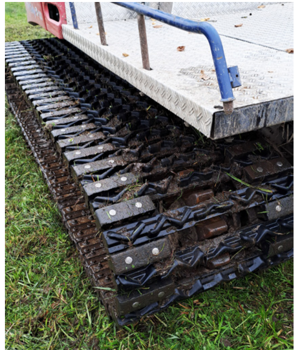
Eine umgebaute Pistenraupe mit speziell angepassten Ketten, die das Einsinken auf nassen Böden und Verdichtungen im Gewende vermindert. Alle Fotos: Dagmar Nitsche, DVL
