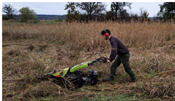
Auf sensiblen Flächen kommen leichte handgeführte Geräte zum Einsatz. Hier ein Balkenmäher.
