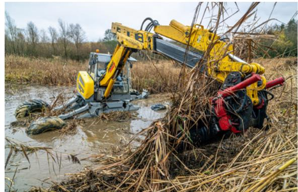
Entfernen von Schilf und Röhricht mit dem Schreitbagger. Foto: M. C. Thumm
