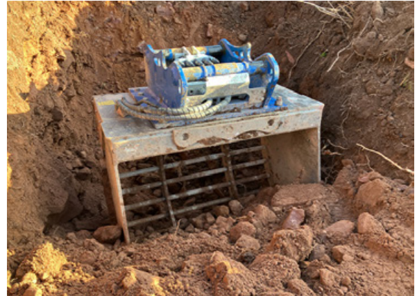
Abb. 2: Zunächst wurden die Steine abschnittsweise abgetragen (links). Große Steine wurden mit dem Sortiergreifer beiseitegelegt, kleine Steine für die Hintermauerung wurden mit dem Sieblöffel (rechts) aus dem Gemisch gesiebt. Fotos: Fabian Anger
